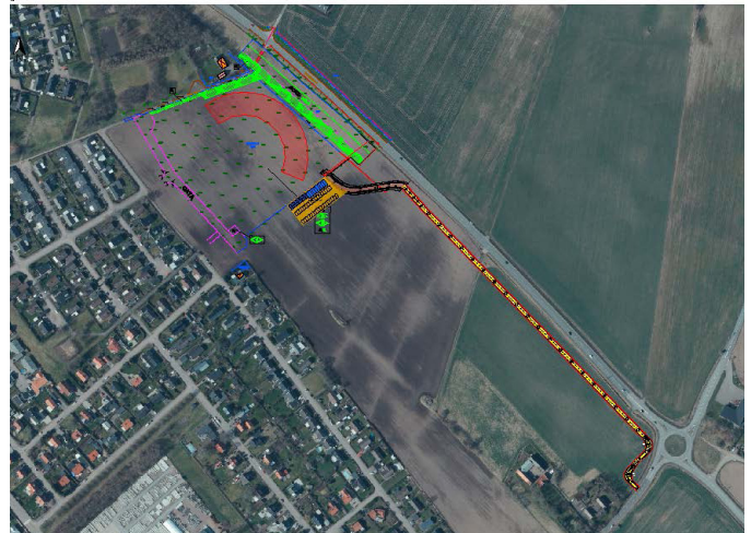
Gul markering visar dragningen av den tillfälliga byggväg som kommer ställas iordning för att hantera merparten av byggtrafiken under byggtiden.
